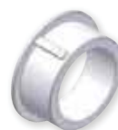
A3505_0505 Adaptation couronne de 35 mm à 45 mm. Permet l'utilisation des adaptations de la série 45. N.B. L'axe de sortie du réducteur est compatible avec toutes les adaptations de la série 45.
